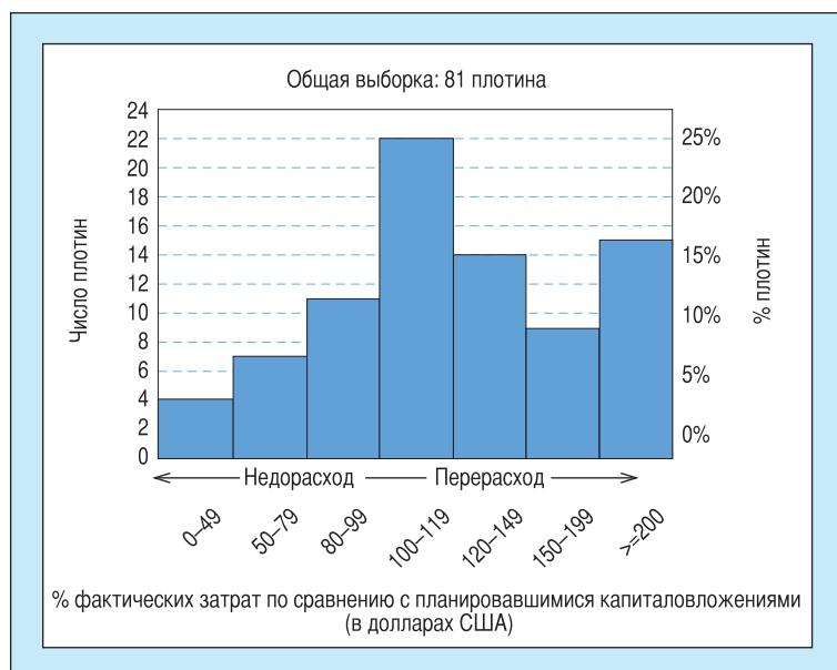
Рис. 2.1 Перерасход средств при строительстве крупных плотин
